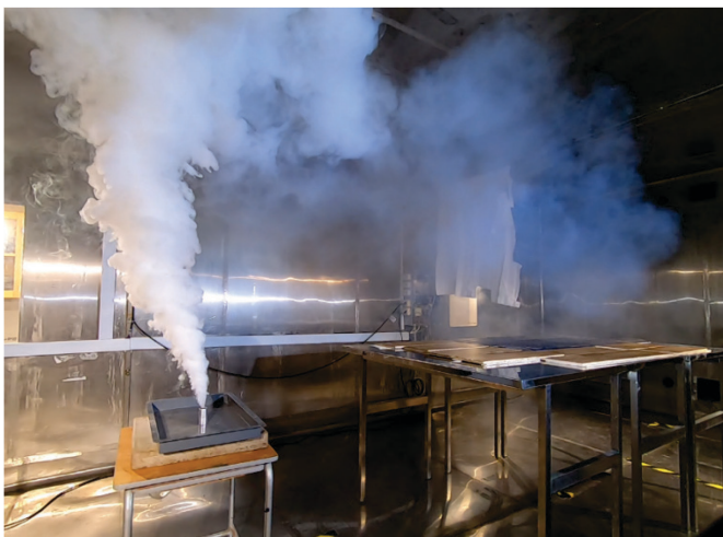
Figur 6. Antändning av tårgasfackla i rökhuset.
