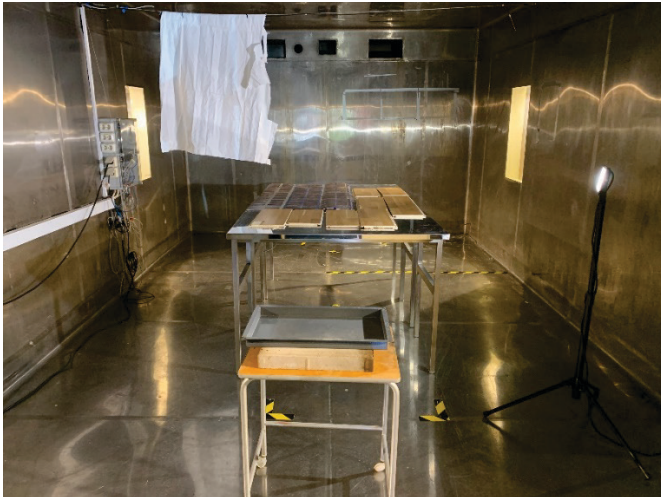
Figur 5. Försöksuppställning i rökhuset med vittnesplattor av parkett- och vinylgolv utlagda på bord och tyg upphängt under tak.
